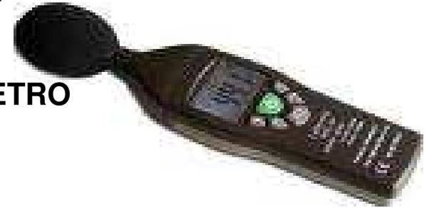
**Dopo aver misurato con il fonometro, il livello di rumore delle macchine o delle lavorazioni, si calcola il LIVELLO DI ESPOSIZIONE del lavoratore (LEX) che tiene conto anche del tempo di esposizione (giornaliero o settimanale)**
